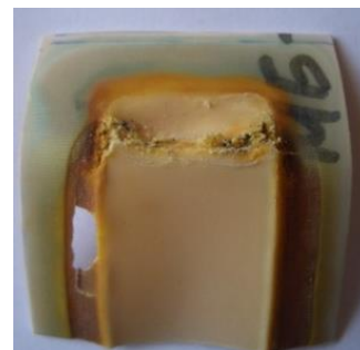
Рис. 2. Разрыв МБ-2 при электролизе БЭД по схеме ЭД (рис.1).
