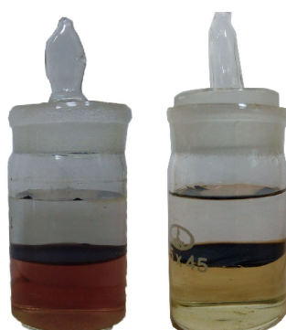
Рисунок 1. Межфазная полимеризация 5,10,15,20-тетракис( p -аминофенил)порфина.
